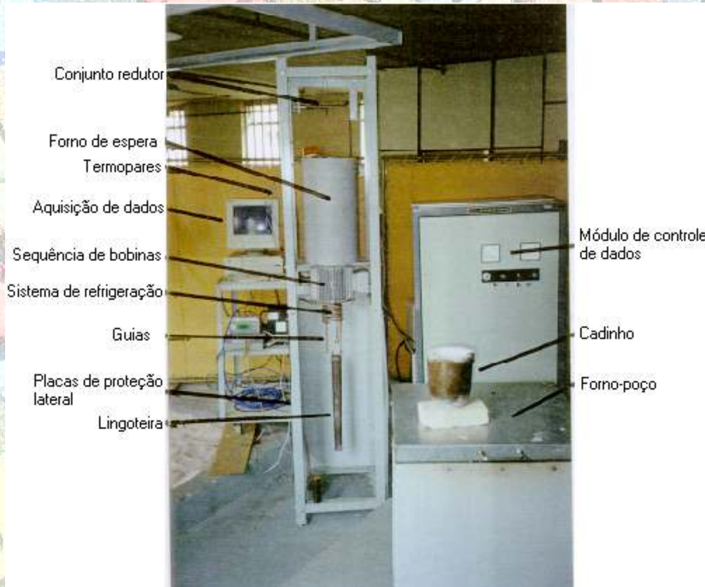
Sistema de Lingotamento Semi-Contínuo c/ Agitação Eletromagnética
